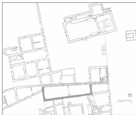
SL. 5. POLOŽAJ SAČUVANOGA ZIDA KAŠTELA U NASELJU (SVIJETLO SIVO) I UVUČENOGA PROPUGNAKULA (TAMNO SIVO) FIG. 5. PRESERVED CASTLE WALL, LAYOUT PLAN (LIGHT GREY) AND RECESSED PROPUGNACULUM (DARK GREY)
